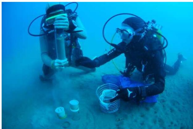
Figure 11 Illustration d'une opération de carottage à la main
