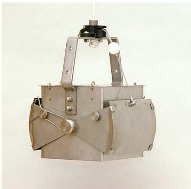
Figure 9 Illustration d'une benne de type Eckman
