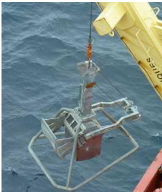
Figure 13 Illustration d'un carottier-boîte
