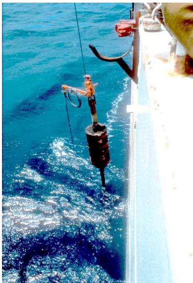
Il se compose d'un lest pouvant atteindre 6 t sur lequel est assemblé un train de tubes acier terminé par une pièce métallique (ogive), profilée pour une bonne pénétration dans le sédiment. Le lest est accroché à un bras de levier (bras déclencheur) sur lequel est fixé un contrepoids qui réalise l'équilibre avec l'ensemble lest et tubes. Ce contrepoids peut être lui-même équipé d'un tube pour échantillonner sans perturbation l'interface eau-sédiment.
