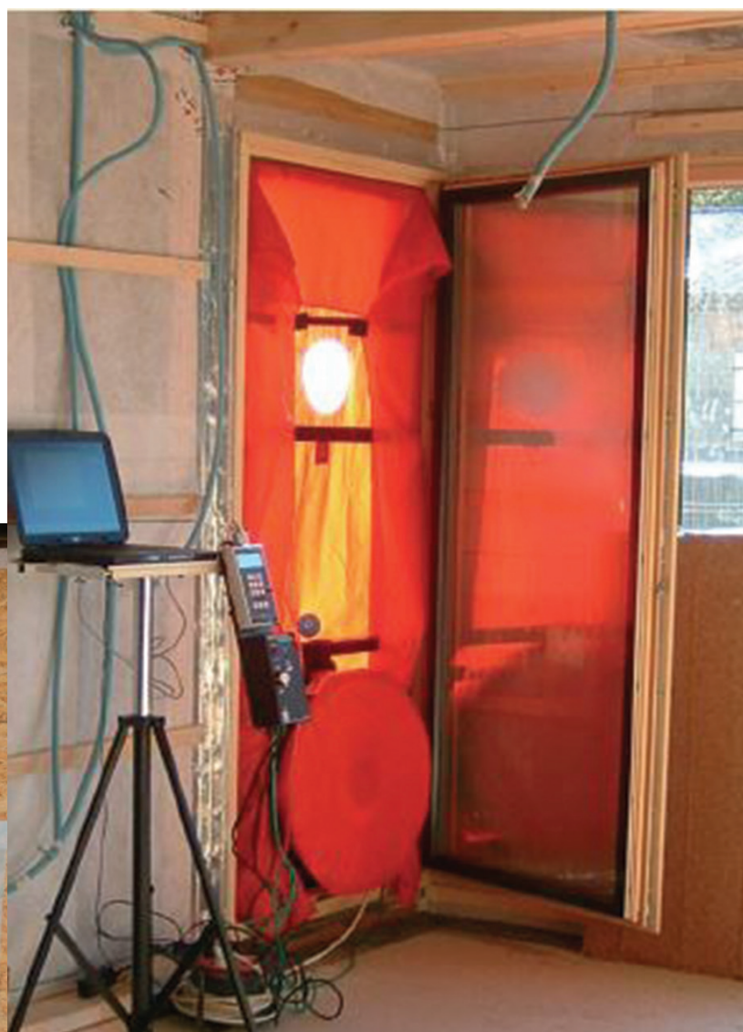
Réalisation d'un test d'infiltriométrie
